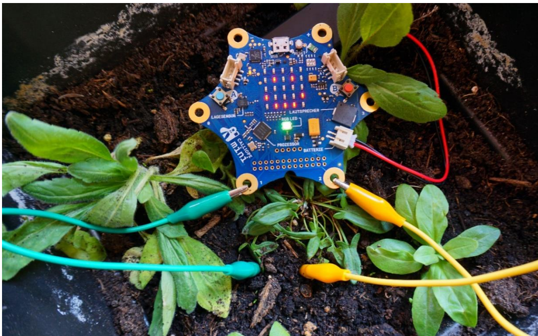
Abbildung 1: Aufbau des Calliope mini zur Messung der Bodenfeuchtigkeit
